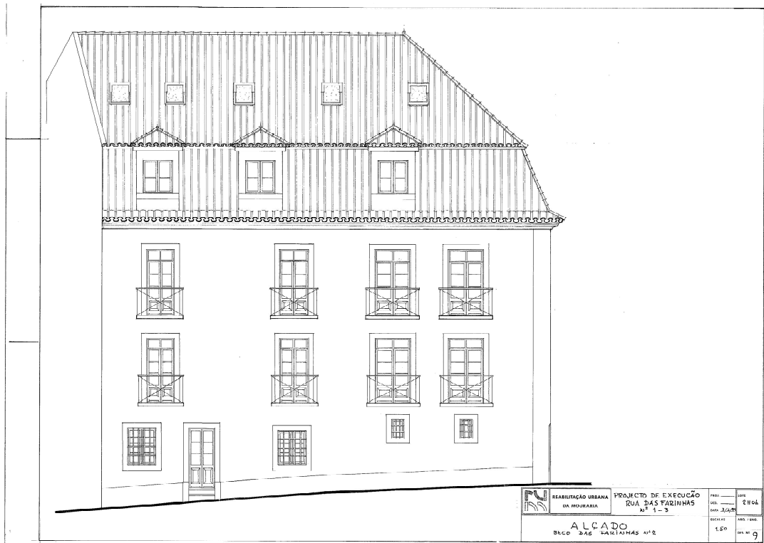
Figura C.15– Alçado Lateral do edifício da Rua das Farinhas 1-3 (fonte: Unidade de Projecto da Mouraria, 2007)
